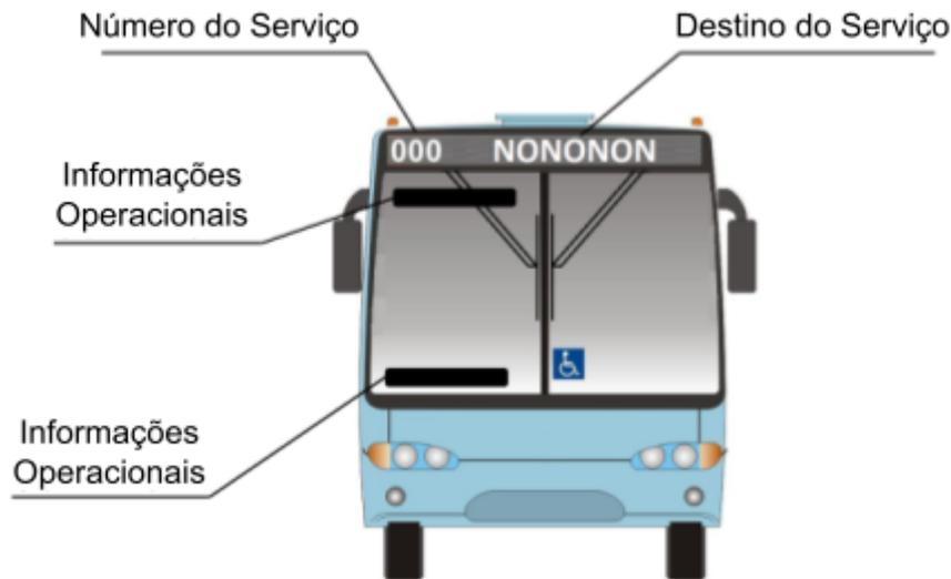
**Figura 2. Comunicação Externa de Veículos do Sistema BRT**
