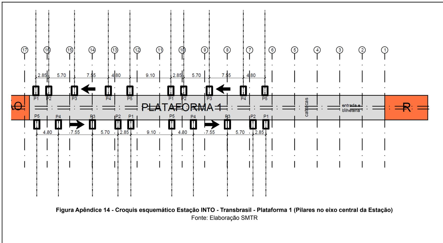
**Figura Apêndice 14 - Croquis esquemático Estação INTO - Transbrasil - Plataforma 1 (Pilares no eixo central da Estação)**
